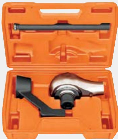
**Corpo e braços de reação em aço especial.****Quadrados de encaixe em aço cromo molibdénio temperado.****Corpo cromado.****Braços de reação e quadrado de encaixe fosfatizados.****Permite aplicação de torque no sentido horário e anti-horário.****Acompanha estojo e manual de operação.****Relação: 5:1****ISO 6789.**
